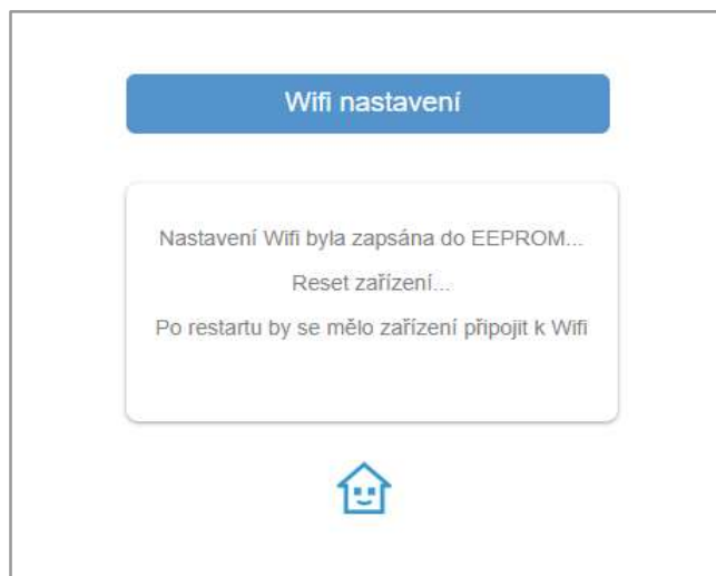
Obrázek 12: Uložení nastavené Wifi a restart
