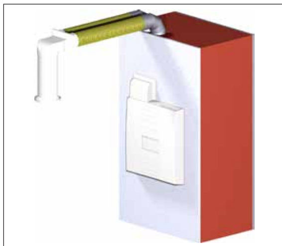
Obr. 4: Montáž pod omítku s kanálovou přípojkou
