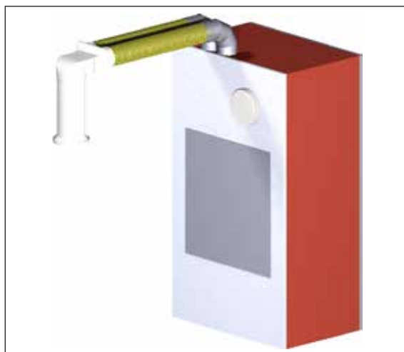
Obr. 5: Montáž s integrací do stěny U 2 s kanálovou přípojkou
